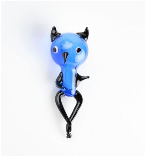
Der Cartesischer Taucher - auch Flaschenteufel oder Wasserteufel genannt - ist ein mit Flüssigkeit und Luft gefüllter Hohlkörper, der als Spielzeug oder als Messgerät für den Druck in Flüssigkeiten dienen kann. Benannt nach seinem vermeintlichen Entdecker, René Descartes, wurde er tatsächlich aber von Raffaello Magiotti 1648 erstmals beschrieben.
